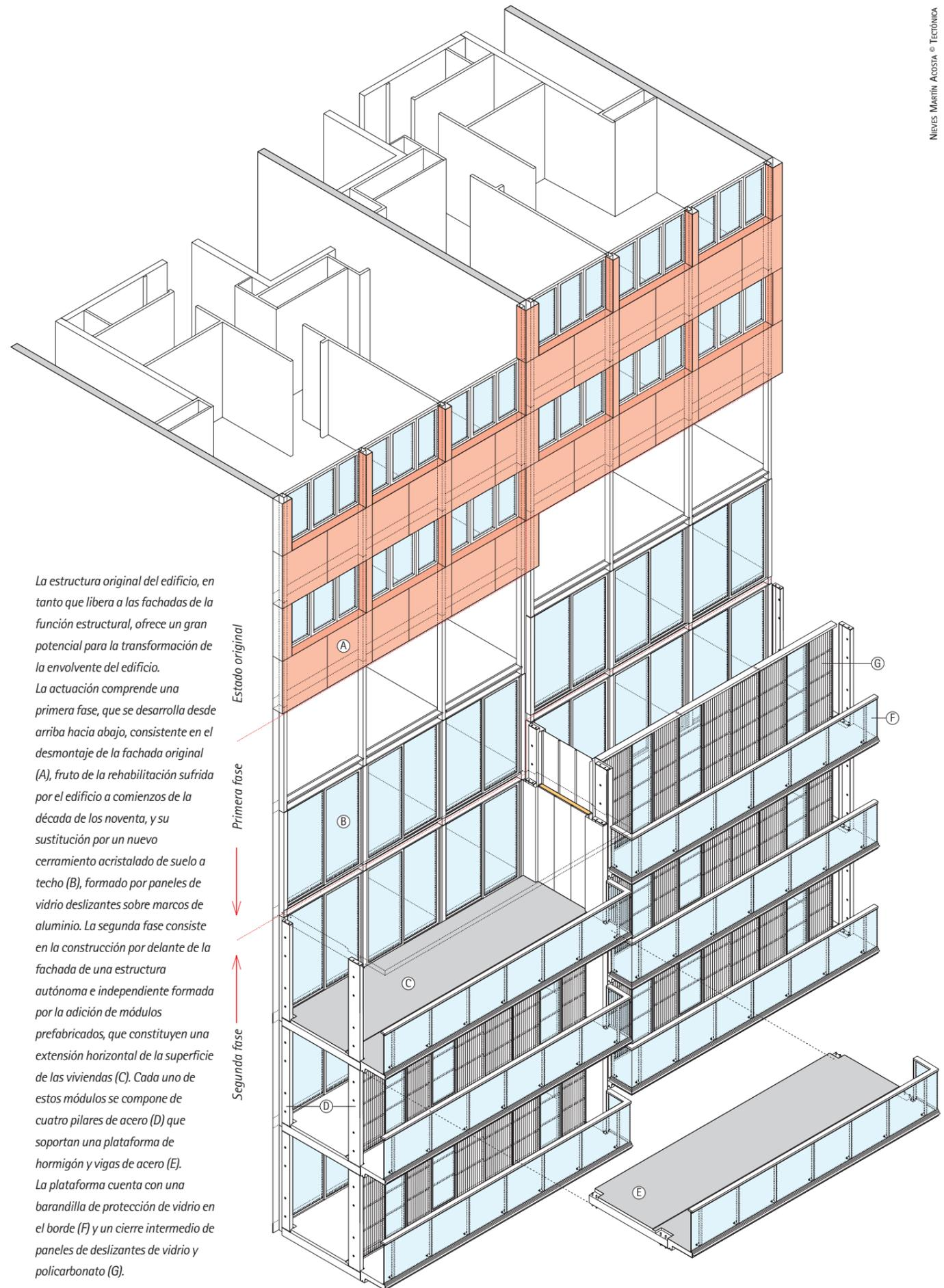
La estructura original del edificio, en tanto que libera a las fachadas de la función estructural, ofrece un gran potencial para la transformación de la envolvente del edificio.
