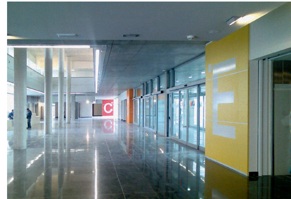
En el vestíbulo se reúnen los seis núcleos verticales, señalados con sus correspondientes colores. Para librarlo del doble techo, las instalaciones se reúnen en un peto
